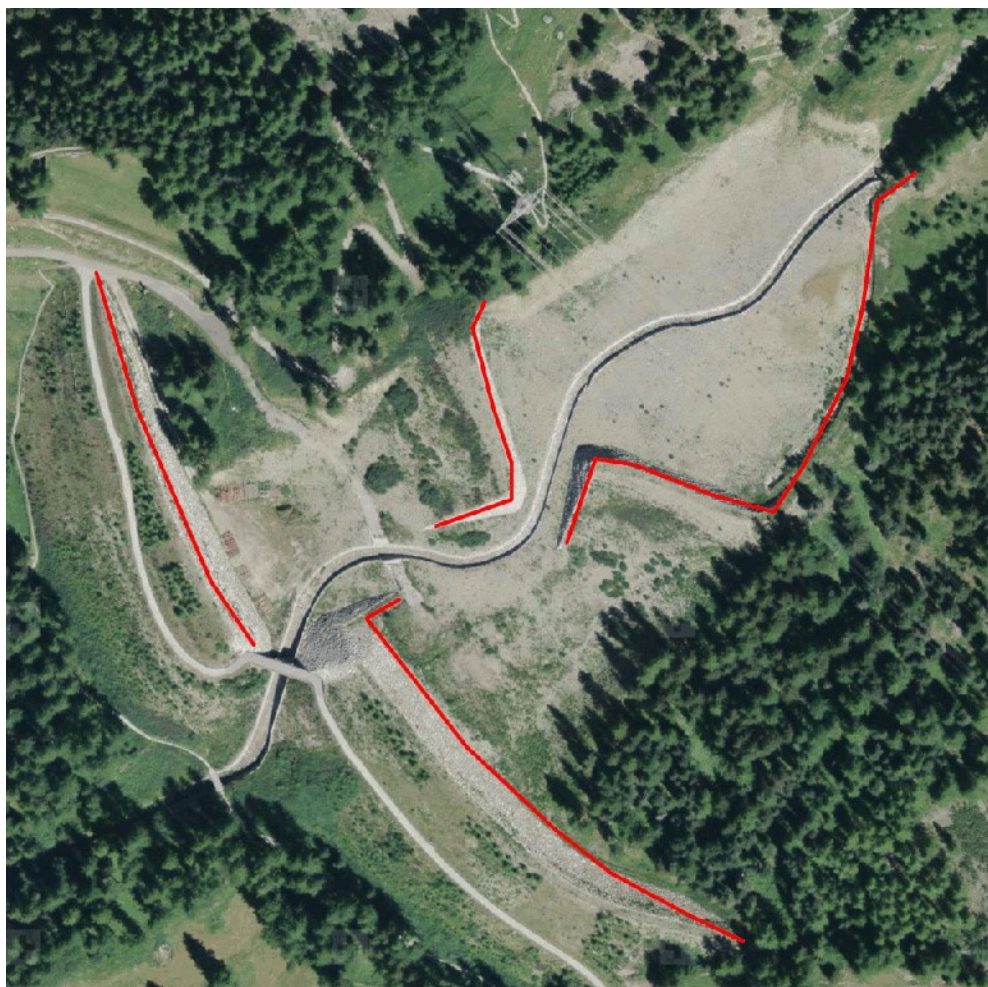
Fig. 16 : exemple d'ouvrage de rétention (la dimension de l'ouvrage isolé à prendre en compte est la longueur totale des lignes rouges.)
